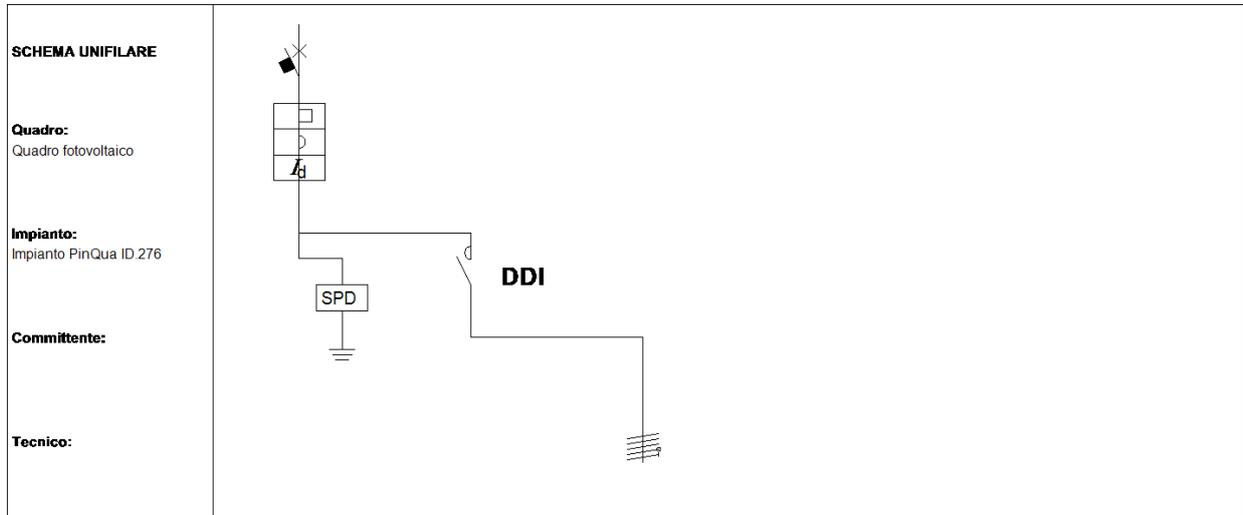
Fig. 5: Schema unifilare quadro "Quadro fotovoltaico"
