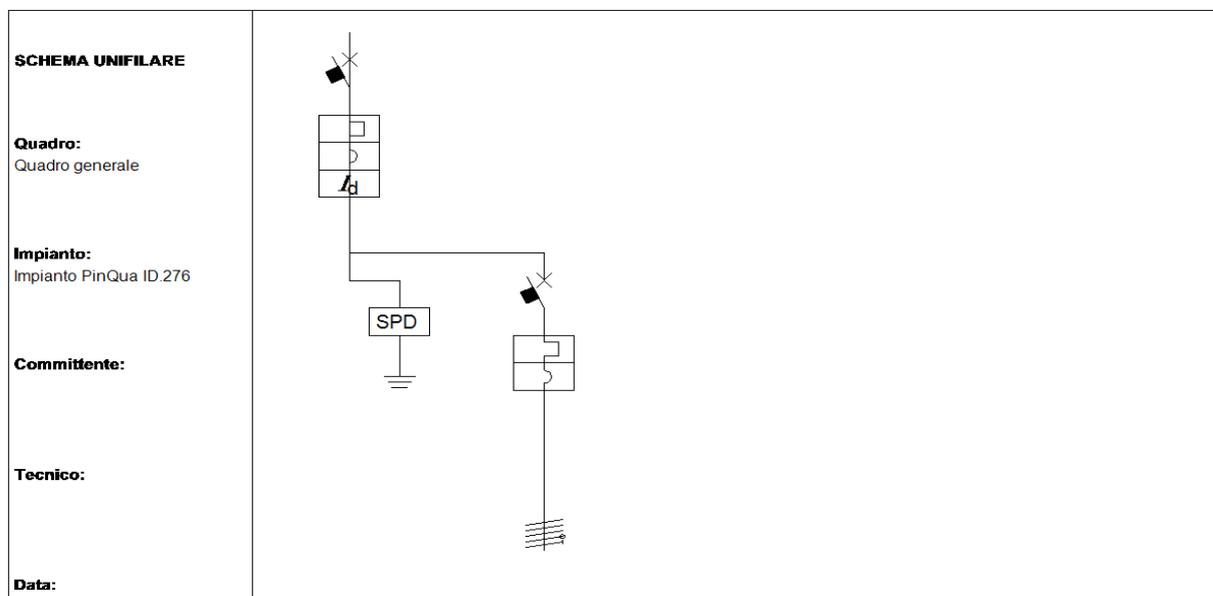
Fig. 4: Schema unifilare quadro "Quadro generale"
