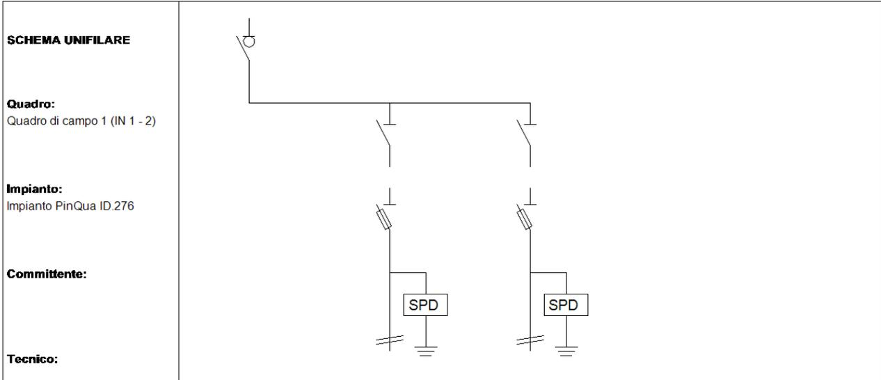
Fig. 7: Schema unifilare quadro "Quadro di campo 1"
