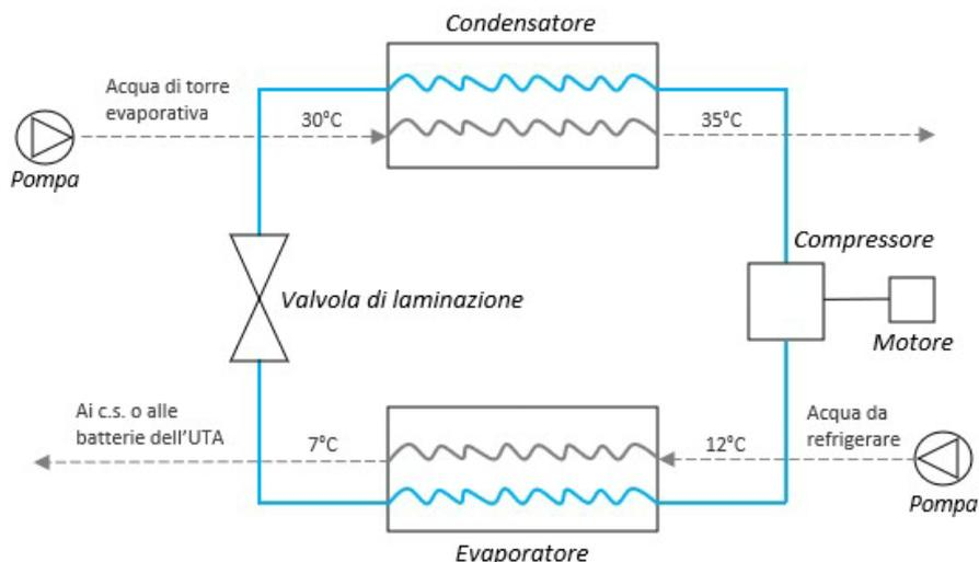
Nel funzionamento da pompa di calore l'energia termica ceduta al condensatore all'acqua di mandata ai corpi scaldanti o alle batterie dell'UTA viene sottratta all'evaporatore esclusivamente da acqua a perdere.
