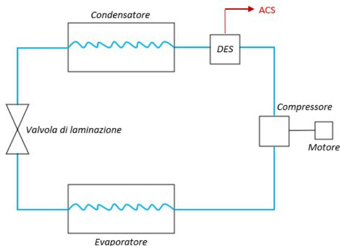
Il gruppo frigorifero a recupero totale, nel senso proprio del termine, recupera completamente il calore rilasciato dal fluido refrigerante durante il desurriscaldamento e la conseguente condensazione. Ciò è possibile attraverso un sistema di regolazione automatica con valvola a 3 vie, con la seconda via verso il condensatore e la terza diretta al recuperatore.
