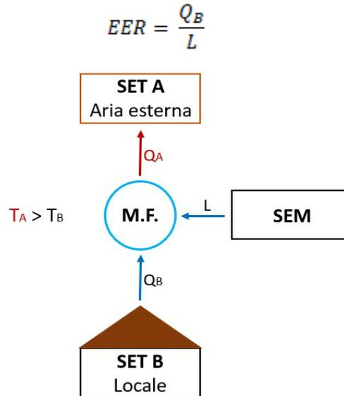
• **Pompa di calore** - il COP rappresenta il rapporto tra l'energia termica da fornire al SET a temperatura superiore e l'energia meccanica spesa:
