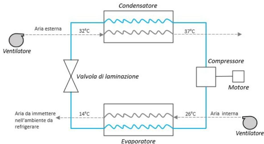
Nel funzionamento da pompa di calore il ciclo si inverte, l'evaporatore è esterno, il condensatore interno, il fluido refrigerante evapora sottraendo calore all'aria esterna, la quale, movimentata da un ventilatore viene spinta all'interno dell'evaporatore, cede calore, si raffredda e passa da circa 2°C a -3°C. Successivamente il fluido refrigerante condensando cede il calore all'aria all'interno del locale che passa da circa 20°C a 28°C.
