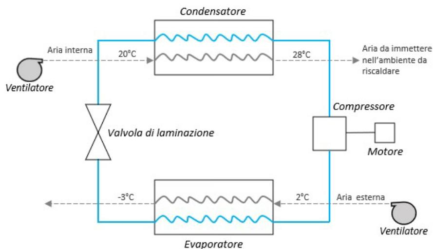
La macchina frigorifera va in sofferenza nelle condizioni in cui vi è la maggiore necessità di essa, ossia all'aumentare della temperatura dell'aria esterna; analogamente vale per il funzionamento da pompa di calore in quanto la prestazione della macchina si riduce al diminuire della temperatura esterna.
