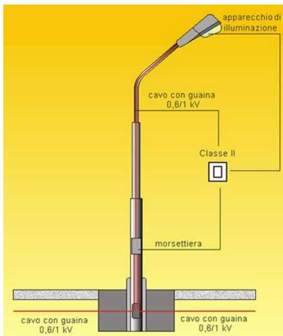
Figura 3: Protezione di componenti di classe II
