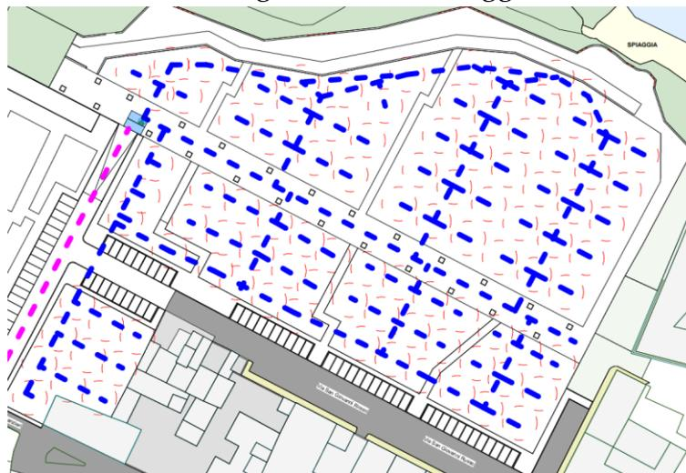
Figura 14: Planimetria di progetto impianto irriguo
