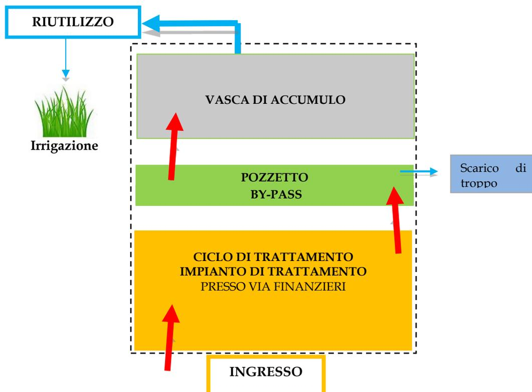
Figura 1: Schema di flusso dell'impianto di irrigazione
