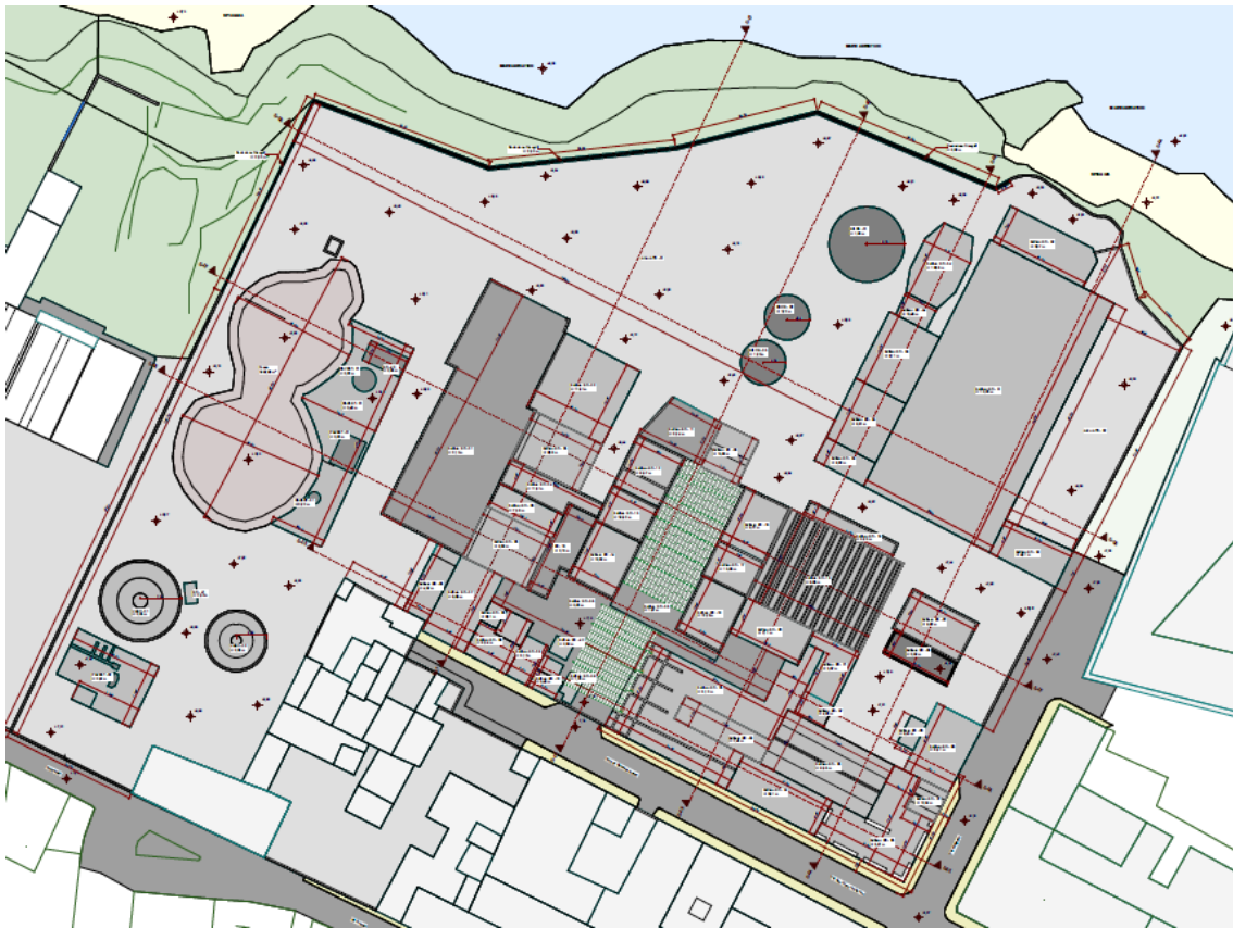
Figura 12: Planimetria delle demolizioni
