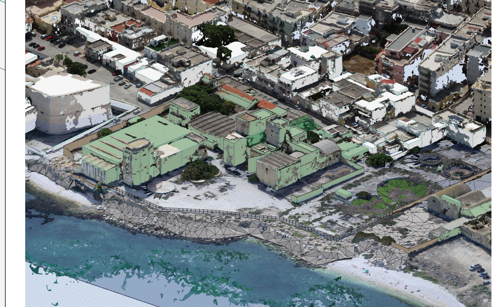
SOVRAPPOSIZIONE MODELLO BIM CON NUVOLE DI PUNTI - VISTA PROSPETTICA
