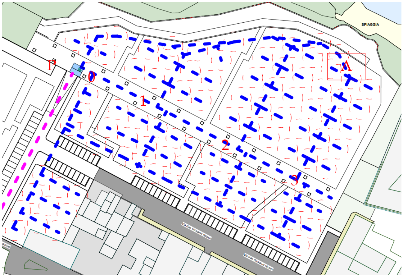
Figura 2: Planimetria di progetto impianto irriguo
