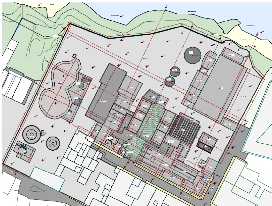
Figura 13: Planimetria delle demolizioni
