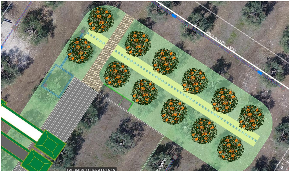
Planimetria della vasca e della trincea disperdente (in giallo)
