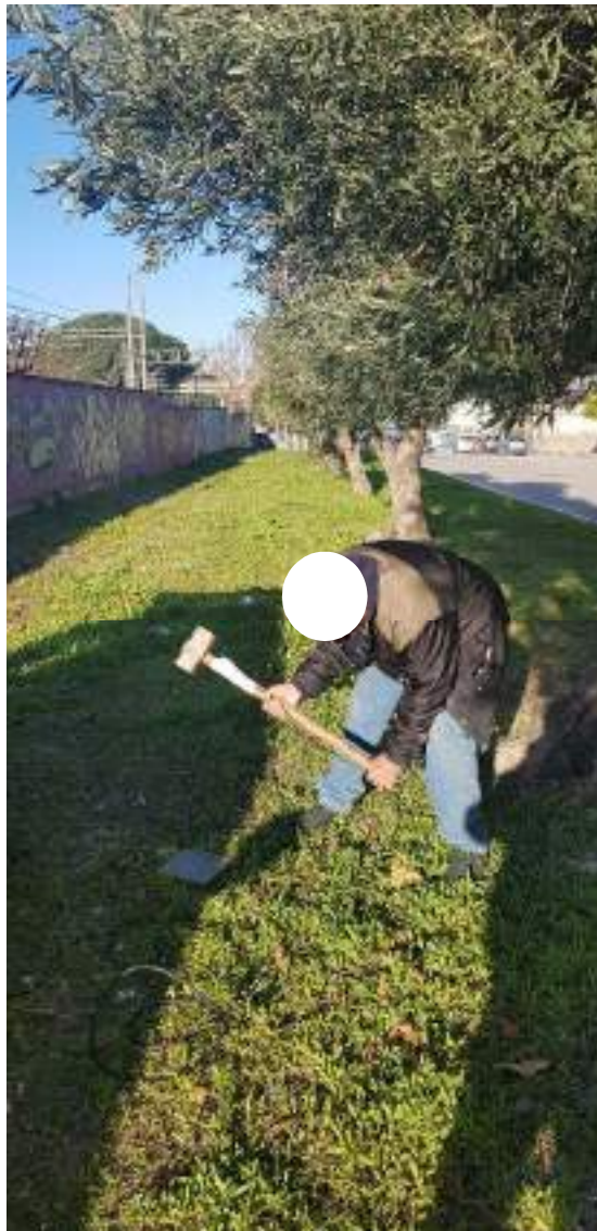
Energizzazione con mazza battente onde longitudinali (Onde P)
