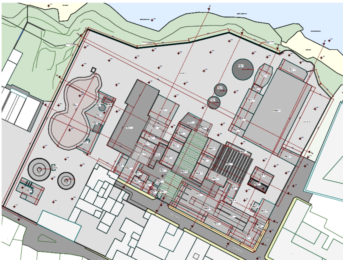
Figura 13: Planimetria delle demolizioni
