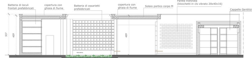
SEZIONE\_PROSPETTO A - A' (CON LAPIDI)
