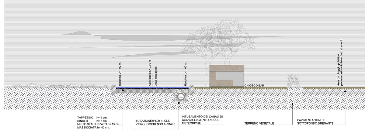
prospetto sezione B\_B
