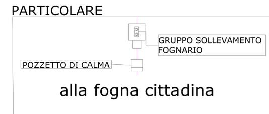
E' prevista la installazione di pozzetti di ispezione posizionati con passo mediamente pari a 12 m, in modo da consentire una agevola manutenzione. I pozzetti previsti sono in conglomerato di cemento delle dimensioni di 50x58,3, con altezza variabile in base alla quota della tubazione. I chiusini saranno carrabili e realizzati con sagoma cava in ghisa riempita del pavimento di pertinenza.
